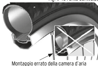
Montaggio errato della camera d'aria
