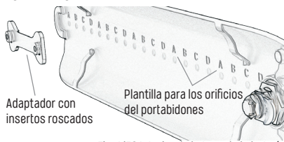
Fig. 1/52 Interior de la tapa de la batería
