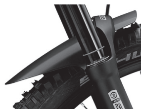
3/9. ábra: „short fender” sárvédő szimbolikus ábra
