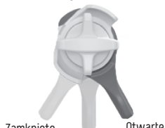
Zamknięte Otwarte Rys. 2/49 Źródło Fox
