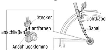
Abb. 1/41 Anschlussklemme Nabendynamo
