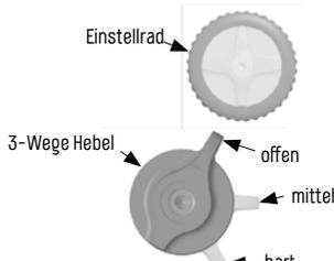
Abb. 2/38 Druckstufe Quelle: Fox
