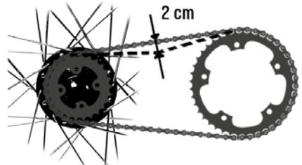
Abb. 4/20 Kettenspannung
