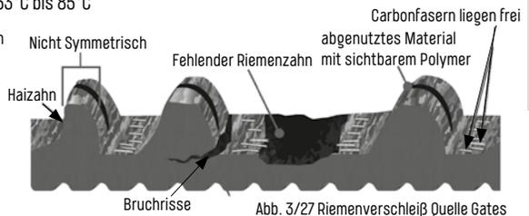
Die richtige Spannung des Carbonriemens ist für eine optimale Funktion des Carbon Drive Systems erforderlich. Eine zu niedrige Riemen Spannung kann beispielsweise dann der Fall sein, wenn die Zähne des Riemens über die Zähne des hinteren Zahnkranzes rutschen. Eine zu hohe Riemen Spannung kann durch eine auffällige Schwergängigkeit des Systems festgestellt werden.
