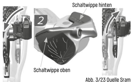
Durch Drücken der Schaltwippe nach oben oder Drücken des hinteren Teils der Schaltwippe (siehe Bild 2 „Abb. 3/ Quelle Sram“ auf Seite 23), wird der gegenteilige Vorgang eingeleitet - die Kette wandert von den großen in Richtung der kleinen Ritzel am Zahnkranz.
