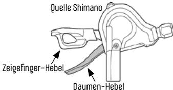
Abb. 4/22 Schalthebeleinheit Schaltwerk
