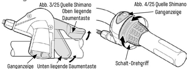
Eine Ganganzeige informiert über den jeweils eingelegten Gang. Durch Drehen des Schalt-Drehgriffs im Uhrzeigersinn, bzw. Drücken der unten liegende Daumentaste, wird eine kleinere Übersetzung eingestellt. Durch Drehen des Schalt-Drehgriffs gegen den Uhrzeigersinn, bzw. Drücken der oben liegenden Daumentaste, wird die Übersetzung erhöht.
